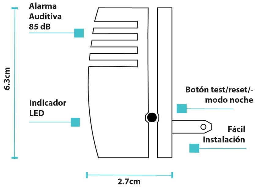
Fig 1. Estructura del detector
